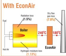
INCREASE IN BOILER EFFICIENCY FROM 3 - 4% DEPENDING ON FUEL AND OPERATING LOADS
